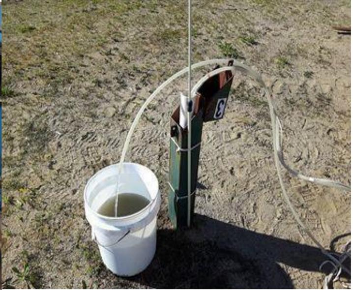
Échantillonnage des piézomètres
