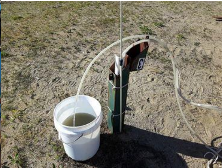
Échantillonnage des piézomètres
